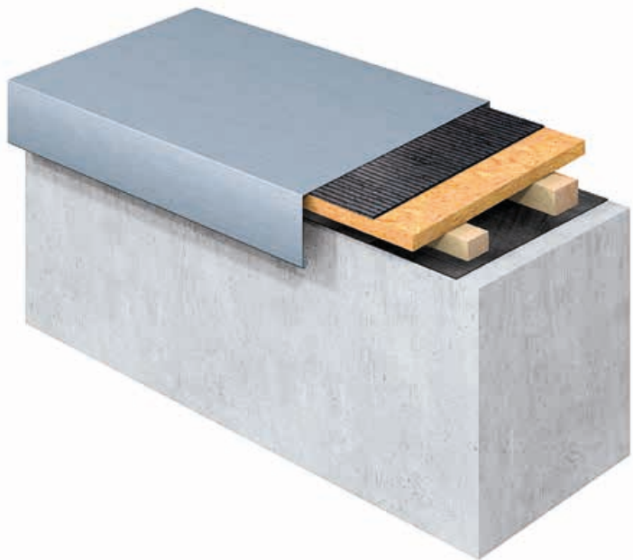
Fig. 15: Revestimento para muro – fixação com adesivo betuminoso em frio
