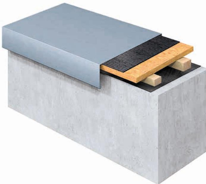
Fig. 15: Albardilla para muro – Fijación con adhesivo bituminoso en frío
