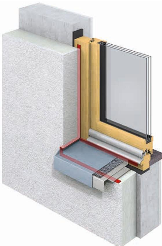
Fig. 31: Posición del sellamiento para evitar la entrada del agua de lluvia
