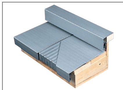
Sección en detalle de revestimiento de cornisa
