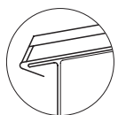
Ukončení okapnice, stojaté šikmé
