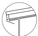
Ukončení okapnice, stojaté kolmé (pouze pro opticky nenáročné oblasti použití)
